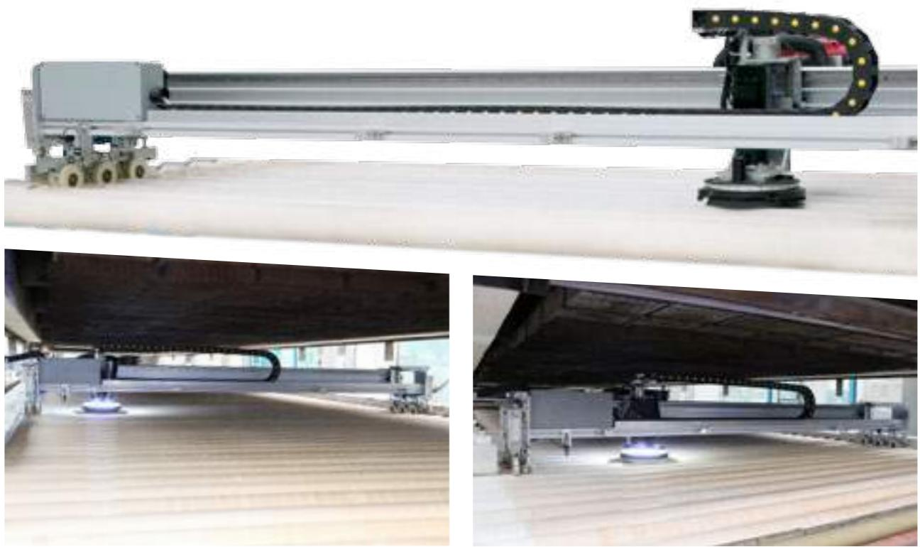
该设备是一种专门针对钢化炉陶瓷辊清洗和抛光工作的智能设备，能够彻底移除在陶瓷辊表面上附着或熔化的任何污物，如玻璃、SO<sub>2</sub>残留物等。在清洗和抛光的过程中，使用特殊工具来保护陶瓷辊表面的完整性，并增加亮度和光泽度，实现了让钢化辊焕然一新和提升玻璃钢化品质的作用。
